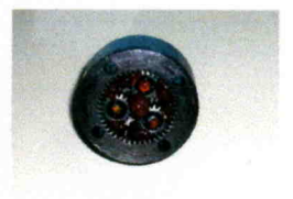
ニードルベアリングと、遊星ギヤ内部にも必ずグリスアップしてください ※グリス注入量：1.0～2.0mL
