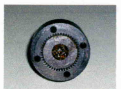
ギヤードンBOX側に、めくら蓋ワッシャーを取り付ける シャフト抜け止め用のスナップリングは、専用プライヤーにて取り付ける ※スナップリングは、一度外すと変形するので、毎回交換してください
