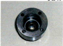
ニードルベアリング以外の軸受ベアリングに パーツクリーナー等は吹きかけないでください
