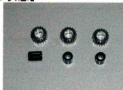
ニードルベアリング以外の軸受ベアリングに パーツクリーナー等は吹きかけないでください
