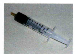
グリスの袋の角をカットして注射器に充填する ※ゴミやホコリが入らないように注意！
