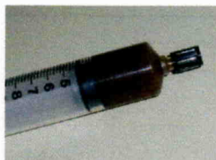
ニードルベアリングと、遊星ギヤ内部にも必ずグリスアップしてください ※グリス注入量：1.0～2.0mL
