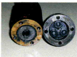
洗浄前のモーター内部
